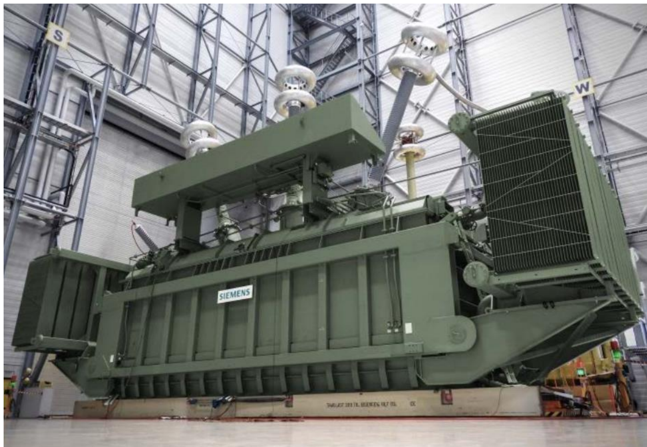
Abb. 1-4: Dreiphasige BLK 420 kV, 50–250 Mvar (Länge 18,7 m, Breite des Tanks 4 m, Breite 7,6 m, Höhe des Tanks 4,5 m, Höhe 11,1 m, Transportgewicht 219 000 kg, Betriebsgewicht 361 000 kg). Quelle [1.1]
