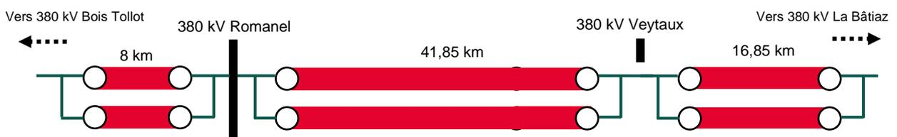
Figure 2-65: Systèmes de câbles de 380 kV à proximité de 380 kV Romanel dans le cas fictif
